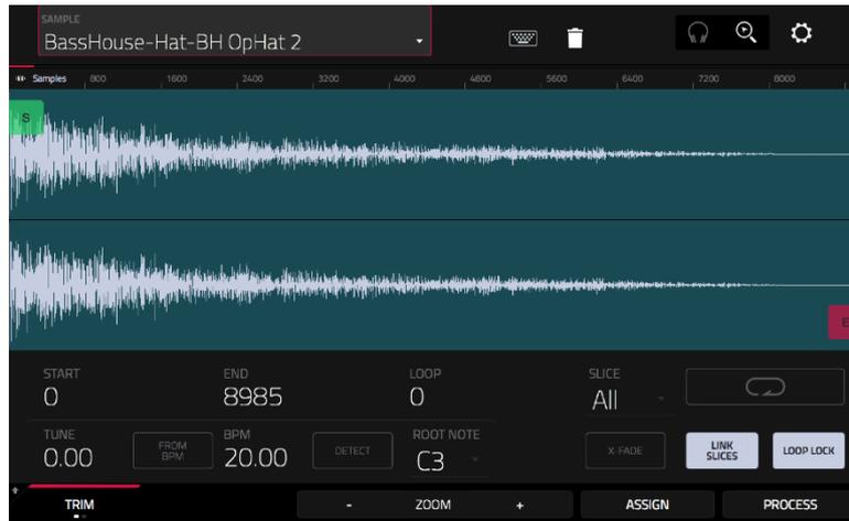
波形ディスプレイには、サンプルのアクティブになっている部分が表示されます。波形を左右にスワイプすることで波形を動かすことができます。
