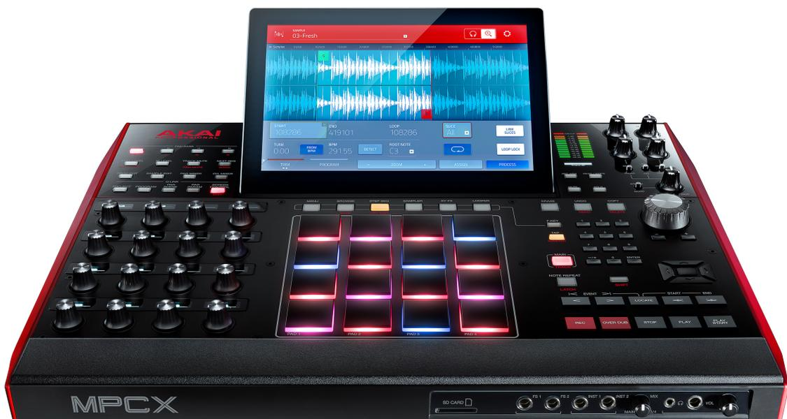
専用のメニューボタン、大きなマスターエンコーダーノブ、16個のタッチセンシティブな360°アサイン可能なポット（Q-Links）搭載。OLEDディスプレイは、個々のパラメータを正確に反映し、直感的な操作を可能にした制作環境を提供します。
